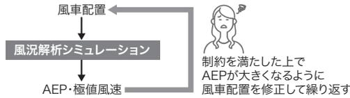
図1. 人手での風車配置設計手法
