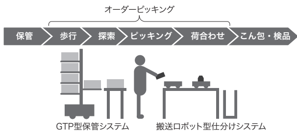
図2. オーダーピッキング作業の概要
