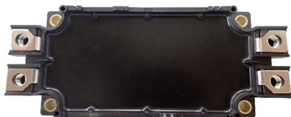
試作したモジュールの外観
