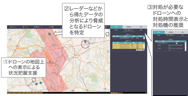
システム統合ソフトウェアによる状況把握 Drone identification and threat analysis using integrated system software
