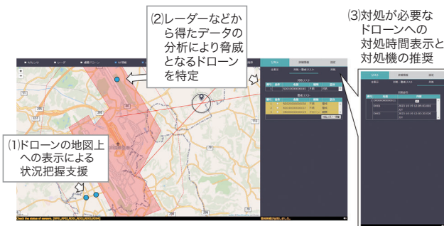
システム統合ソフトウェアによる状況把握 Drone identification and threat analysis using integrated system software
