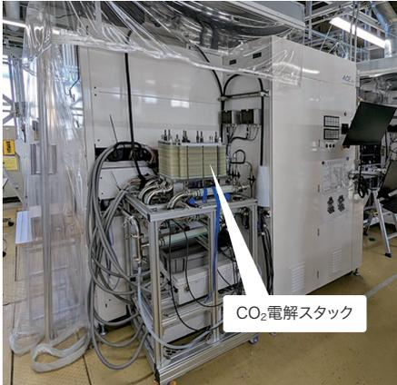
実機サイズ CO<sub>2</sub> 電解スタックと電気化学評価設備
