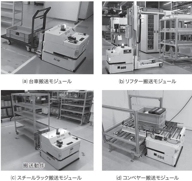
図7. ロボットプラットフォームによる機能拡張
