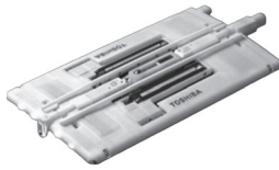
図6. タービン発電機用薄型検査ロボット
