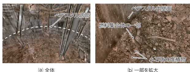
図5. 2号機におけるペDESTAL底部全体図と燃料集合体の一部
