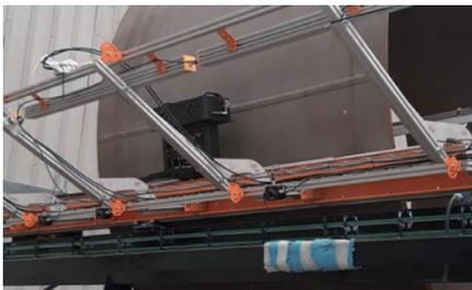
風力発電用タワーの外観及び溶接形状の自動検査装置
