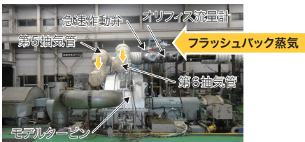
縮小モデルタービン検証試験装置 Subscale model turbine test facility
