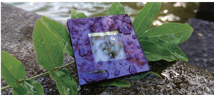
ダブルガラス封止型ペロブスカイト太陽電池の耐水性 Waterproofing of perovskite solar cell by double glass encapsulation
