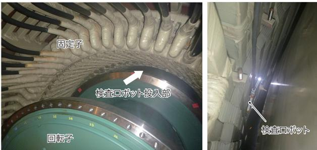
検査ロボットによる詳細検査の様子
