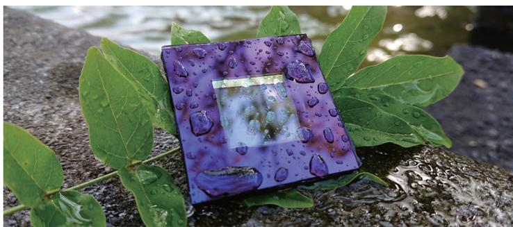
ダブルガラス封止型ペロブスカイト太陽電池の耐水性
