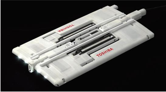
タービン発電機向け検査ロボット
