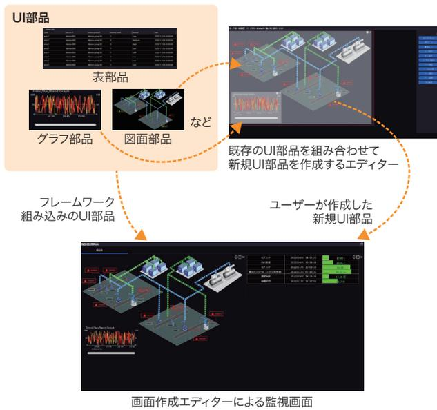
UI部品を組み合わせ設計された監視画面の例
