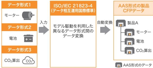
ISO/IEC 21823-4による異なる形式間のCFPデータの自動変換の例
