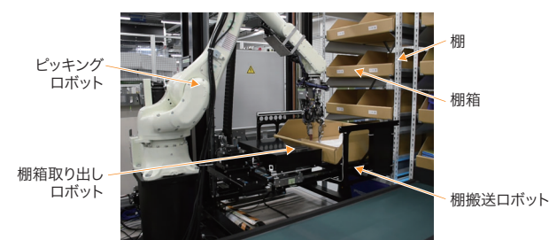
ピッキングロボットの作業場所におけるピッキングの様子 Picking operation in picking robot work area
