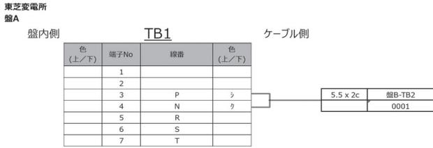
図7. デジタルデータを用いたケーブル布設図の表示例
