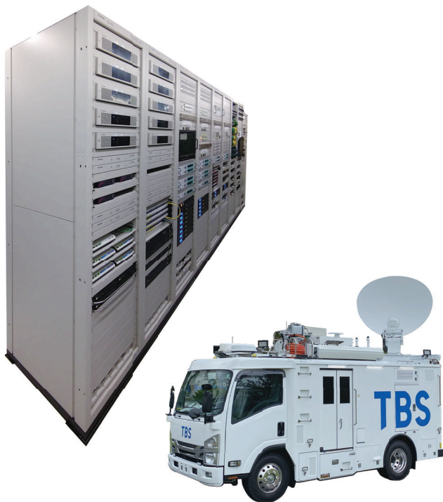
（株）TBSテレビのSNG車載局及びSNG 主局設備ラック群
