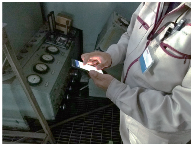
無線端末を使ったデータ伝送のフィールド試験
