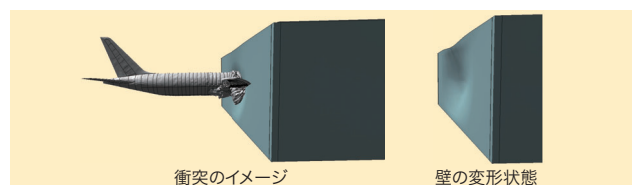
大型航空機の衝突に対する原子炉建屋構造の解析評価
