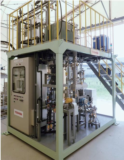
CO<sub>2</sub> 分離回収試験装置
