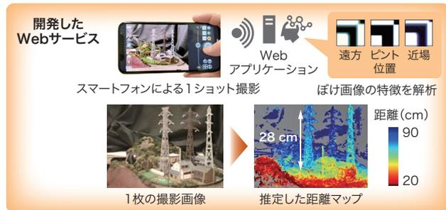
インフラ保守点検では、劣化箇所の大きさを短時間で手軽に計測したいというニーズがある。従来、画像から被写体の大きさを計測するには、カメラに奥行き情報を取得するためのデバイス(マルチカメラやLiDARなど)を追加する必要があった。そこで、スマートフォンで撮影した写真1枚から、画像の奥行きを計測するWebアプリケーションを開発した。
