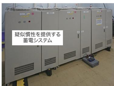
慣性力を提供するGrid forming inverterを検証する実証実験装置
