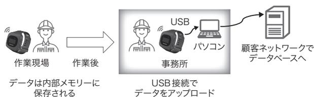
図4. スタンドアローンモード時のデータフロー
