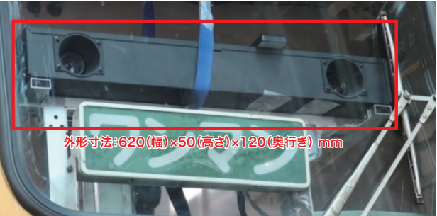
図6. 車両に仮設した前方検知装置の試作機
