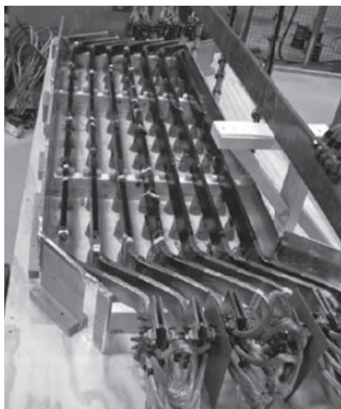
図4. 回転子コイルの熱サイクル試験
