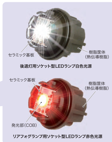
*光源サイズ：取り付け部直径26 mm, 全長33 mm
