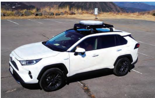
自動衛星追尾アンテナを搭載した車載局
