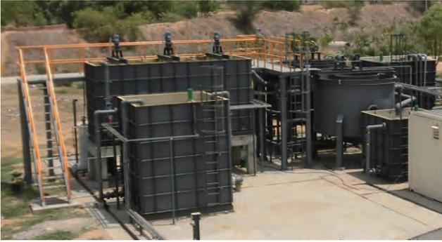
大容量高速沈殿槽の実証試験設備
