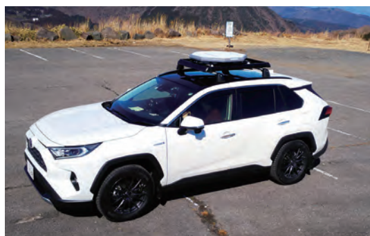
自動衛星追尾アンテナを搭載した車載局 Satellite communication vehicle equipped with autotracking satellite antenna
