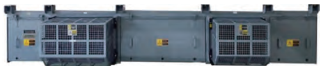
主変換装置 Main converter/inverter
