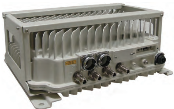
5G 対応光リピーター装置の子機 Remote unit for fifth-generation (5G) distributed antenna systems (DAS)
