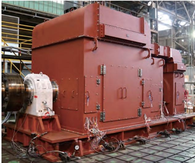
4 極 1,700 MVA 級タービン発電機用ブラシレス励磁装置
