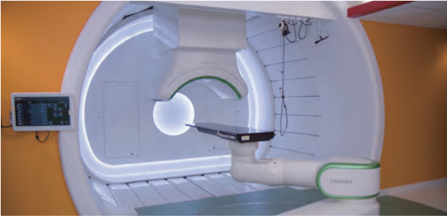
山形大学医学部 東日本重粒子センターの小型超伝導回転ガントリー照射治療室
