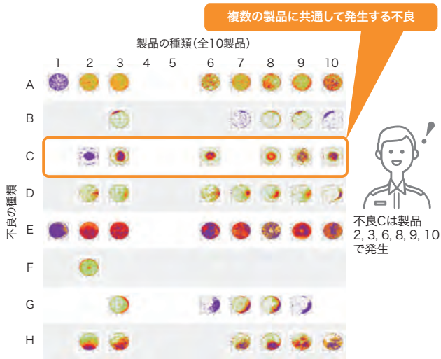
異なる半導体製品に共通して発生する不良の可視化システム Failure visualization system to automatically classify failures common to different products in high-mix low-volume semiconductor manufacturing processes
