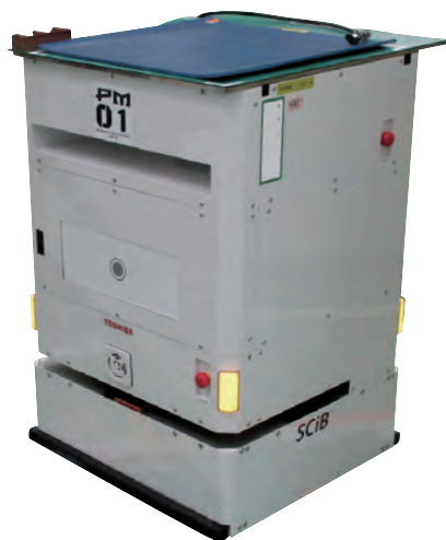
レーザー距離センサーとメカナムホイールを採用した自律移動ロボット Autonomous mobile robot equipped with laser distance sensor and mecanum wheels
