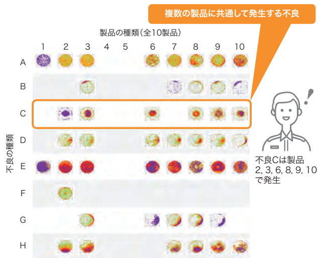
異なる半導体製品に共通して発生する不良の可視化システム
