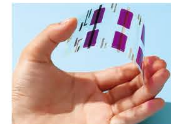
[開発したフィルム型光センサ(厚さ100µm)]
