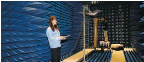
高速無線技術 / High Throughput Wireless Technology 複数アンテナにより電波の指向性を適応的に制御することで、多ユーザー同時利用環境下でも、安定した高速通信ができます。
