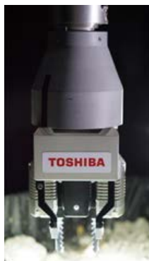
2号機原子炉格納容器内部堆積物調査装置
