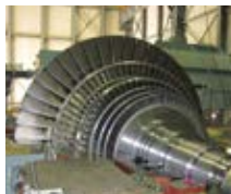
実機サイズ蒸気タービン試験設備
