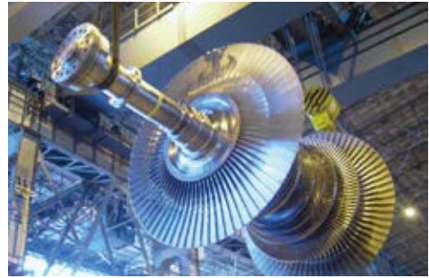
発電用蒸気タービン
