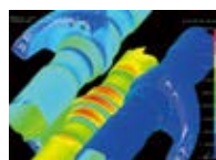
GIS*スパーサの電界評価 *GIS:ガス絶縁開閉装置
