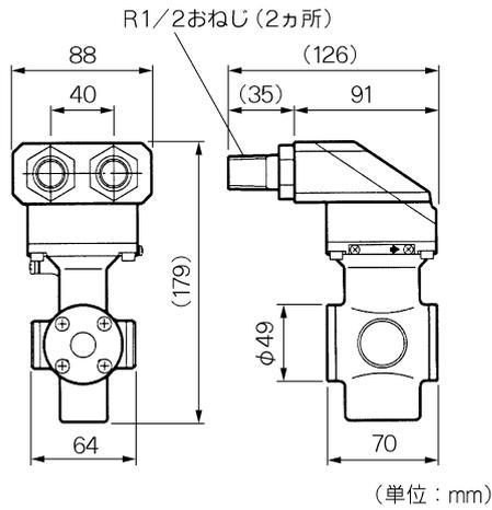
図6 分離形検出器(呼口径：15mm、質量約2kg)
