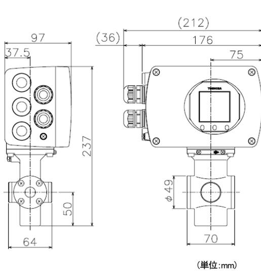
図3 一体形電磁流量計 LF410/LF620
