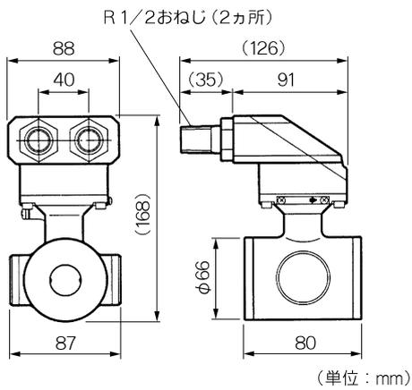
図7 分離形検出器(呼口径：25mm、質量約2.5kg)
