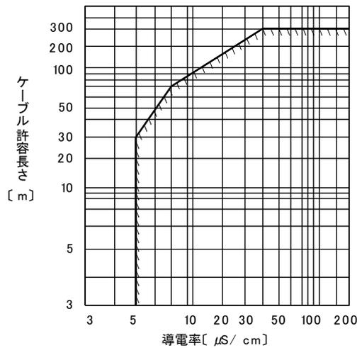
図 11 導電率-ケーブル長さ関係図
