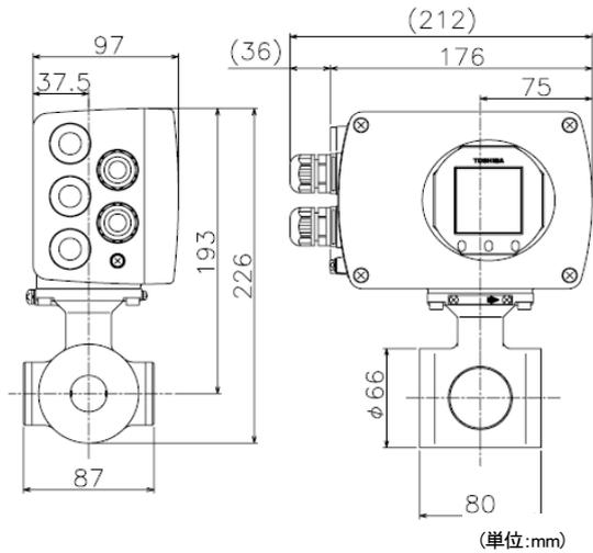
図4 一体形電磁流量計 LF410/LF620
