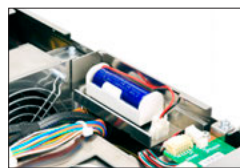
バッテリー交換
