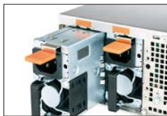
電源ユニット交換
