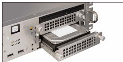
ドライブユニット 前面交換
