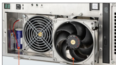
バッテリー 前面交換 ファン 前面交換
