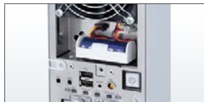
バッテリー 前面交換
