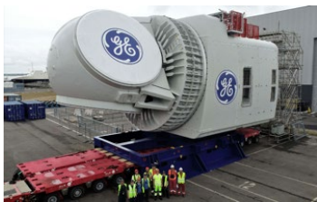
Haliade-X ナセル組立完成写真
