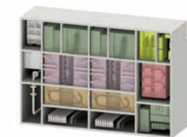
2-MPU (1,400 kW), 1-APU (230 kVA)
