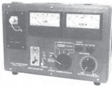
第26図 耐電圧チェッカ正面外観
