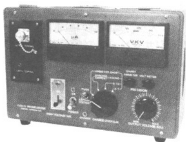
第 40 図 耐電圧チェッカ正面外観
