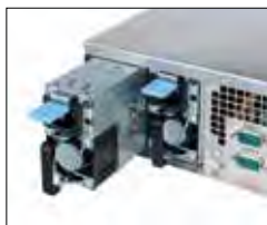
電源ユニット交換
