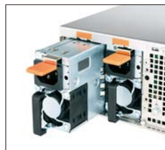
電源ユニット交換
