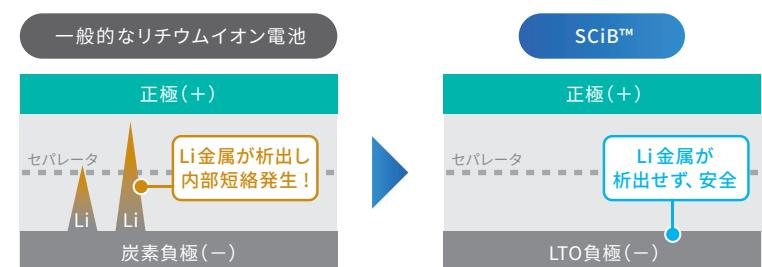
一般的なリチウムイオン電池では、低温環境下や長期にわたる使用、大きな電流を流すことによってリチウム金属が析出しやすくなり、セパレータを突き破って内部短絡に至ることがあります。SCiB™ではリチウム金属の析出がありません。
