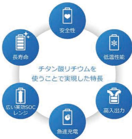
SCiB™は酸化物系材料の採用などにより、長寿命性能を有しています。20000回のフル充放電※1後の容量維持率は70%強となります(9000回のフル充放電後の容量維持率は90%です)。
