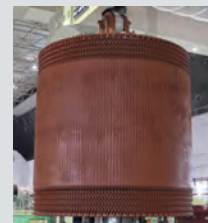
可変速発電電動機回転子 Rotor of adjustable-speed generator-motor
