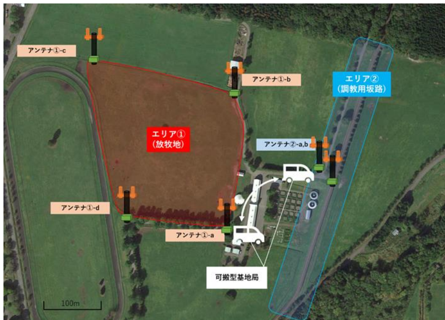
分散アンテナシステムによるローカル5Gエリア構築 (放牧地に加え、調教用坂路にも設置。可搬型基地局の移動で両エリアの通信制御に対応)
