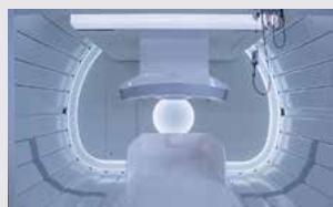
2016 世界初 超伝導電磁石を採用した 重粒子線回転ガントリー 協力：QST/iQMS
